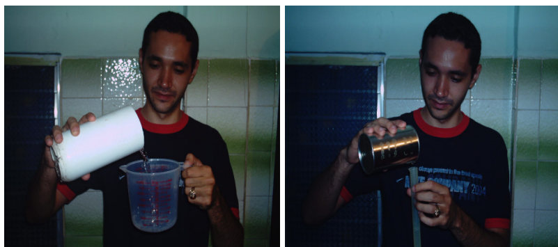
Figura 7:- Lecturas volumétricas de la precipitación
