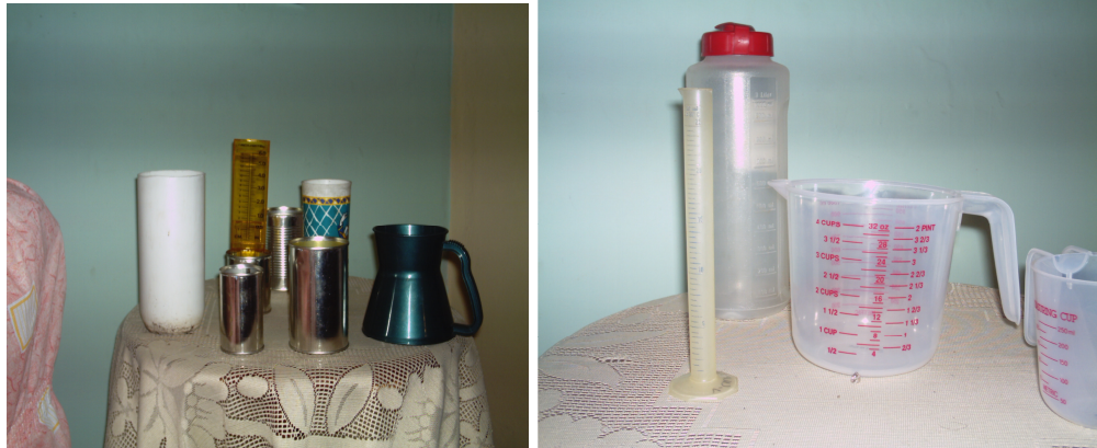
Figura 6. Recipientes utilizados como pluviómetros y cilindros para medición volumétrica
