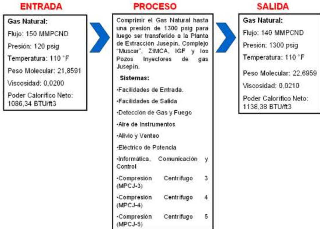
**Figura 5.4.** Diagrama EPS de Miniplantas Compresoras Jusepín (Planta Completa)
