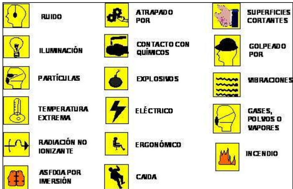
Figura: 3.5. Ejemplo de la simbología utilizada en la construcción de mapas de riesgos Fuente: Internet, http://www.estrucplan.com.ar/articulos/verarticulo.asp?idarticulo=1129
