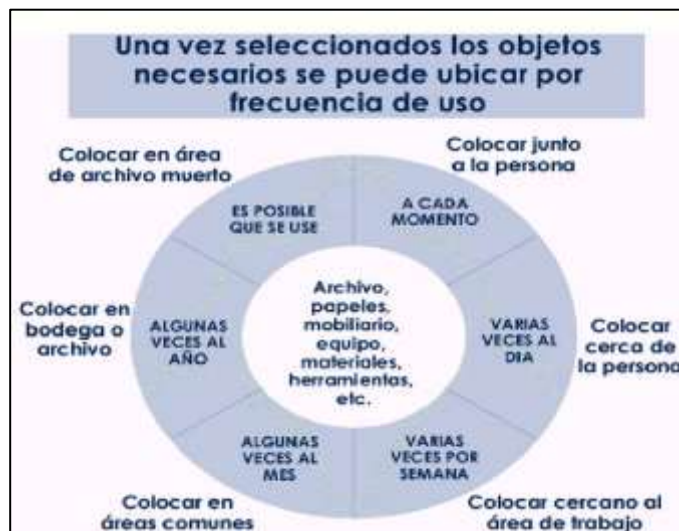
Figura: 3.2 Diagrama de flujo para implementar el seiton Fuente: Corporación Autónoma Regional de Santander
