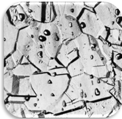
e) Corrosión intergranular del acero inoxidable 317
