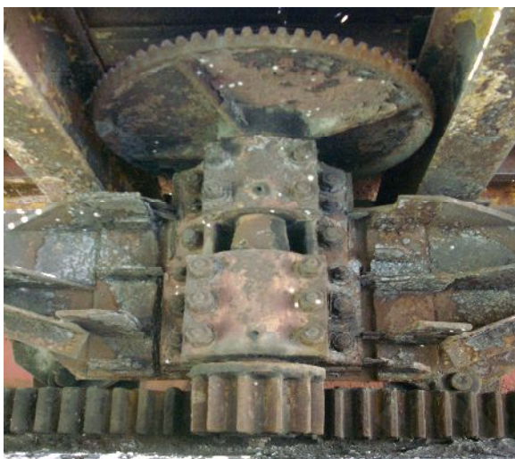
Figura 1.6 Corona Superior, Árbol, Chumaceras, Piñón, Cremallera inferior, planchas y vigas
