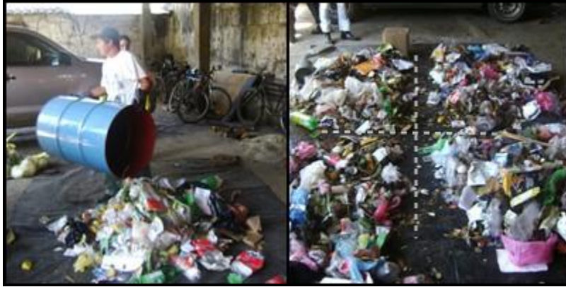
Imagen 4. Método del Cuarteo.
