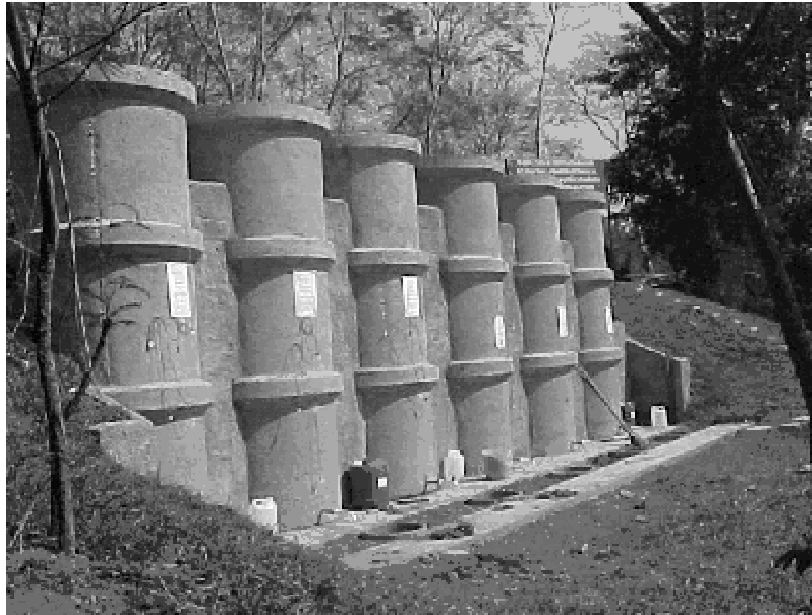
Figura 1. Vista geral das manilhas de concreto usadas na formação das colunas de resíduo sólido urbano
