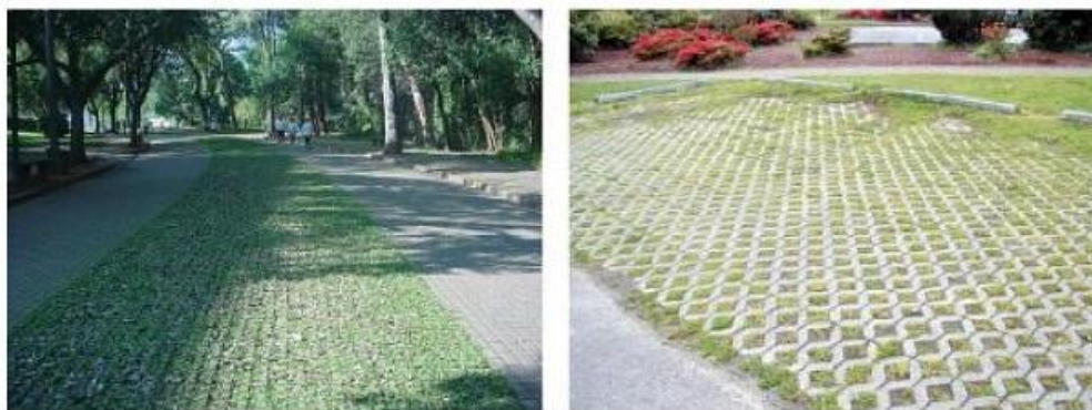
Figura 12 - Adaptado pavimento poroso Parque Ibirapuera, São Paulo, 1996 Fonte: CANHOLI (2005, p.43)
