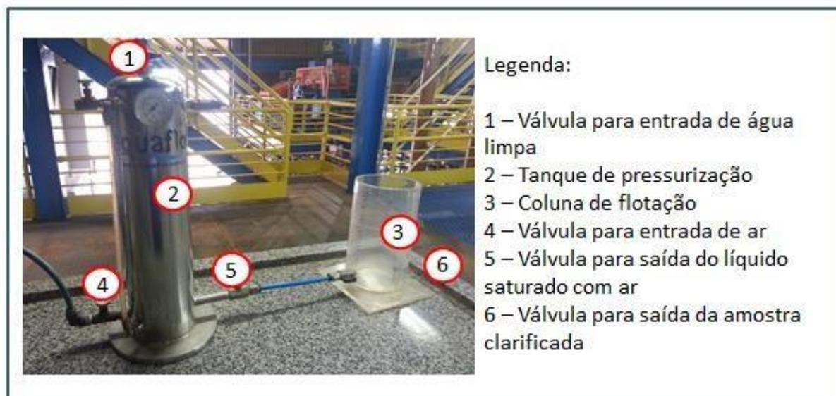
**Figura 24:** Aparato experimental de FAD em escala de bancada.
