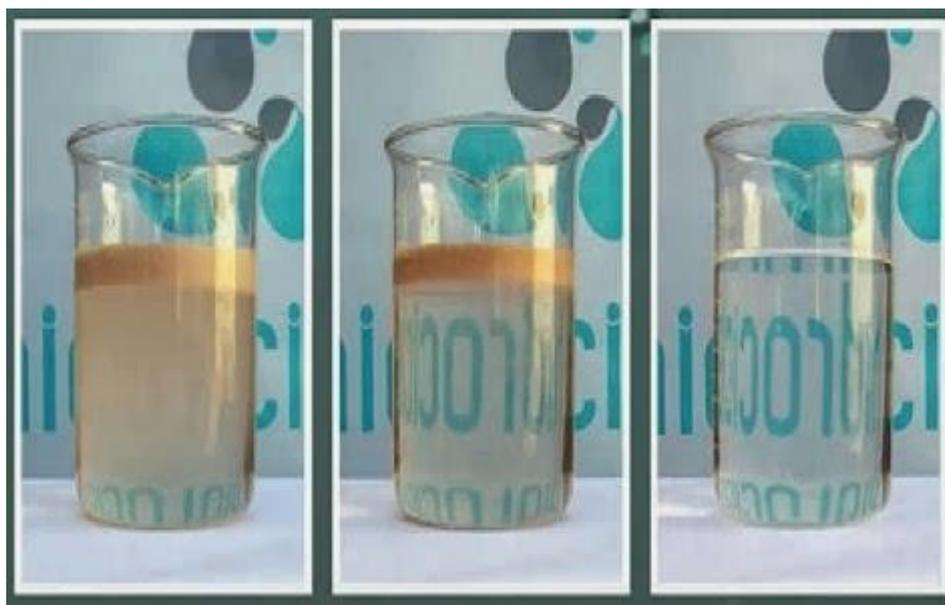
**Figura 01:** Eficiência do processo de tratamento de água de lavagem de veículo através da Floculação Flotação.
