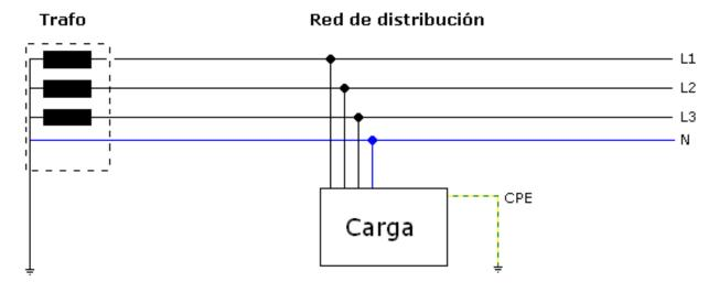
En este esquema el neutro del transformador y las masas metálicas de los receptores se conectan directamente, y sin elemento de protección alguno, a tomas de tierra separadas.
