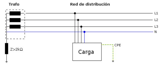
Este es el esquema que ofrece una mayor continuidad de servicio, ya que corta el suministro al segundo defecto, a diferencia de los otros que lo hacen al primero. Ello se debe a que en un primer defecto la corriente se encuentra con una resistencia muy grande para retornar al transformador y se puede considerar un circuito abierto. Un segundo contacto provocará una circulación de corriente y actuarán los dispositivos de protección.
